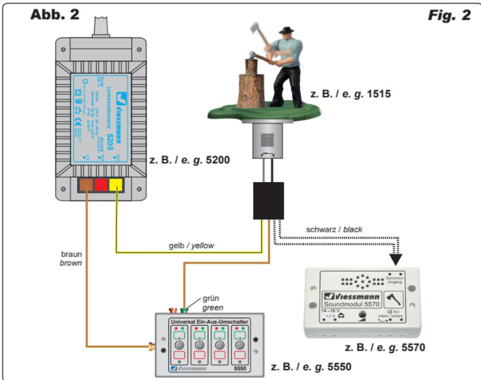
Zum einfachen Ein- und Ausschalten des Modells, verwenden Sie einen Schalter (z. B. Art.-Nr. 5550) (Abb. 2).
