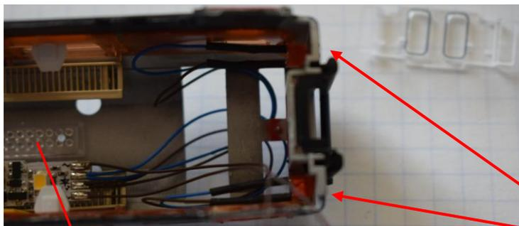
Mettre double face côté intérieur pour fixation de la patte de la LED
