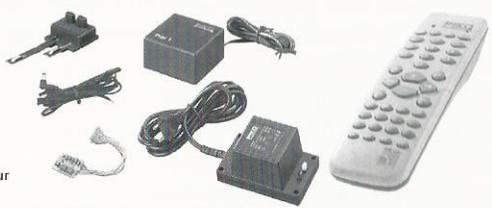
Il ne faut pas brancher un transformateur d'une puissance supérieure à 45 VA
